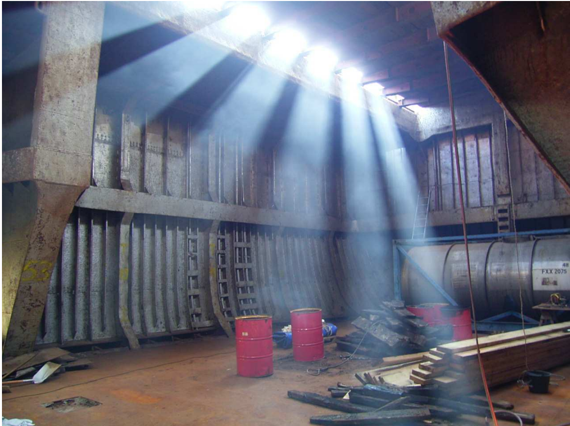
Die Ruhe nach getaner Arbeit. Die Bilgen in Luke 2 sind offen. Nach der Reinigung und der Messung der Außenhaut kann die neue Wegerung eingebaut werden. Das Material liegt schon in der Luke bereit (rechts im Bild).
